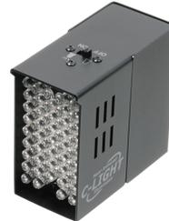
本体に電池 BOX 機能を内蔵し、別売の外部電源にも対応したコンパクトな赤外線投光器です。波長のピークを 940nm とした不可視 LED を採用。肉眼で見えにくい特長を備えています。投光距離 5メートル程度。
