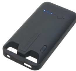
スマホケースに擬装したデジタルビデオカメラです。撮像素子に 1/4 インチ高画質 CMOS を搭載。操作系は録画スイッチ一つと、ステータス確認ボタンのみで構成。感覚的な操作が可能です。某社スマホ 4/4s、5/5s 対応。
