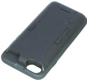
スマホケースに擬装した、1080p デジタルビデオカメラです。Wi-Fi 機能を搭載しているため、装着したスマホからアクセスすれば撮影アングルの確認が可能です。4 倍デジタルズーム機能付。某社スマホ 6/6s、7/7s 対応。
