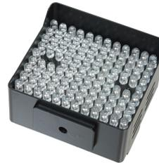
波長のピークを 940nm とした近赤外線投光装置です。肉眼では光源が見えにくいのが特長です。コンパクトなボディに 104 灯の国産ガリウム砒素 LED を配列。安定した照射能力を有します。
