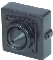
CP-M2 は 500 万画素の高画質メガピクセル CMOS カメラです。AHD, CVI, TVI, CVBS の出力に対応。25x25mm 角の小設計デザインは監視からモバイルまで幅広く活躍します。ピンホールレンズタイプ。
