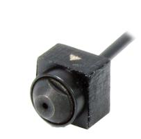
CM-D6L はサイズにこだわった超小型カラー CMOS カメラです。そのサイズだけでなく最低被写体照度 0.3Lux を有するなどスペックも充実しています。レンズ f3.5mm モデル。
