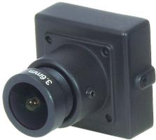
CP-M1 は 500 万画素の高画質メガピクセル CMOS カメラです。AHD, CVI, TVI, CVBS の出力に対応。25x25mm 角の小設計デザインは監視からモバイルまで幅広く活躍します。ボードレンズタイプ。
