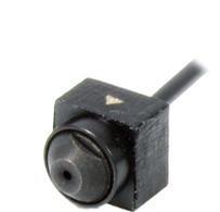
CM-D6 はサイズにこだわった超小型カラー CMOS カメラです。そのサイズだけでなく最低被写体照度 0.3Lux を有するなどスペックも充実しています。レンズ f3.5mm モデル。
