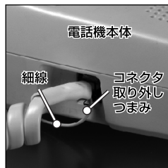
写真1 BTT-900接続状態
