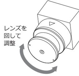
CM-D5では、フォーカス調整が可能です。レンズの先端を回して調整してください。「△」のプリントのある方が上になります。
