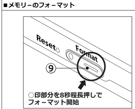
**8** PC-350GXでメモリーのフォーマットができます。④の状態でもフォーマットボタン(⑨)を8秒程長押しします。青LEDと赤LEDが点滅します。点滅が終わり青LEDのみ点灯になったらフォーマット完了です。
