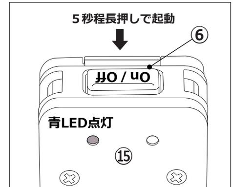
**4** 電源兼録画ボタン(⑥)を長押し (5秒程) して電源を入れます。電源が入ると背面の青LEDが点灯します(⑮左側)。
