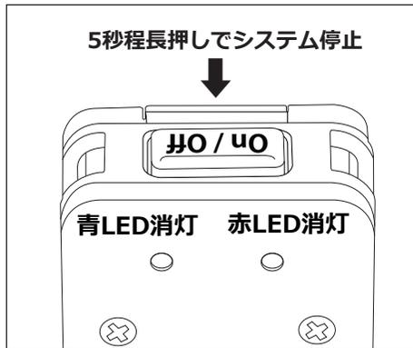
**7** PC-350GXの電源を切る場合は、電源兼録画ボタンを長押ししてください。電源が切れると青LEDが消灯します。
