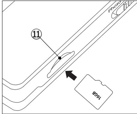
**1** PC-350GXのmicroSDスロット(⑪)にmicroSDカードを挿入します。この際、カードの向きにご確認ください。
