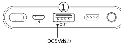
PC-700Wの主たる機能はデジタルビデオカメラですが、外部機器へ給電できる出力を有しています(①)。給電用のケーブルを2種類同梱しています。これらのケーブルを使って、本体のDC5V出力と外部機器を接続して給電します。
