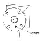
③ 装着完了。同梱の両面 テープをブラケットの 設置面に貼ります。
