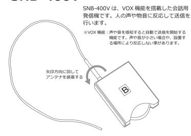
①まずはアンテナを装着してください。アンテナ端子にねじ込むだけで固定されます。アンテナは出来るだけ伸ばしてご使用ください。 SNB-400Vは高感度なマイクを使用している為、どの方向からでも良く音を拾いますが、マイクを塞ぐと音が聞こえなくなりますので、使用する際はご注意下さい。
