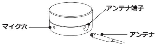
②次にフタ(アンテナ端子が無い方)を回して外します。電池は刻印を上に向け、(-)の表記がある方へ斜めに滑らせる様に入れます。電池のセットが終わったら、フタを回して閉じてください。電池が装着された時点で、発信されます。電池寿命は約30時間です(連続で発信し続けた場合)。
