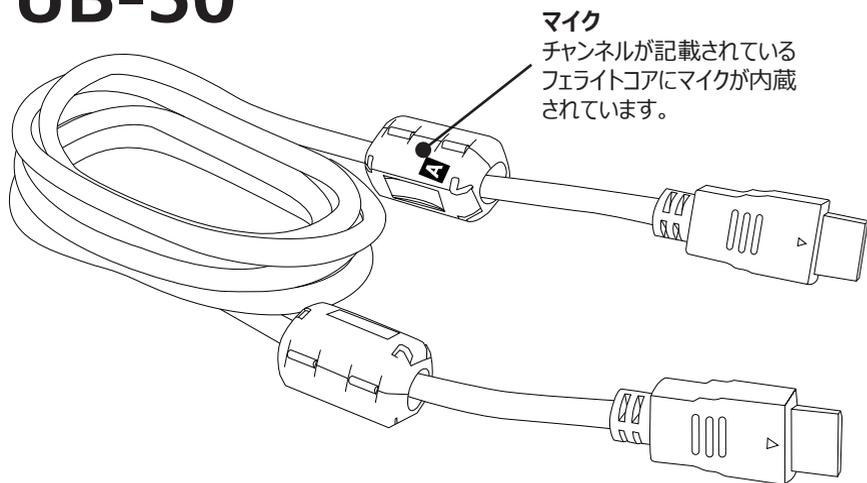
UB-50はHDMIケーブルにUHF発信機を組み込んだ製品です。映像出力機器に接続すると発信します。HDMIケーブルとしての機能はそのままですので、モニターに接続すれば映像を写すことができます。映像を出力していない状態やモニターに接続していない状態でも、映像出力側の機器がスタンバイ状態等、HDMIケーブルに電源が供給されていればUB-50は発信します(※)。UB-50は本体に高感度なマイクを内蔵しており、周囲15m程度であれば小さい音でも集音可能です。
