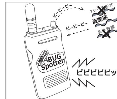
**4** a~cの中で、発見作業中の室内で、バグスポッターが発する識別音を拾えるのはbの盗聴器のみです。盗聴器はこの識別音を拾うと、それを含んだ電波を送信します。バグスポッターはその「識別音を含む電波」を受信すると警告音を出して盗聴電波の存在を知らせます(ピピピピッ)。バグスポッターが検知した電波が識別音の情報を含まない場合、警告音は出ません。通常、数十秒~1分程度で識別音は停止します。
