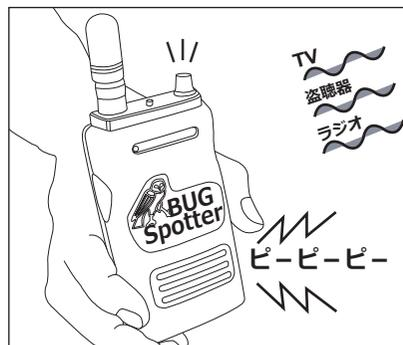
**3** スキャン中に下記電波を受信すると識別音(ピーピー..)を発生します。電波の発信源が盗聴器か否かを識別するためです。
