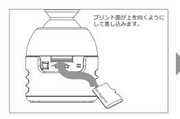
(1) 機関部保護カバー(各部名称参照)を右に回し、microSD スロットを露出します。microSD カードを microSD スロットに挿入します。プリント面が上を向くように入れてください。
