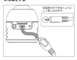
まず最初に充電を行ってください。付属の USB ケーブルを CAR-5 に接続します。この時、プラグの向きにご注意下さい。CAR-5 が左図の様に位置する時、プラグの突起部が下を向くように挿し込みます。 USB ケーブルのもう一方を電源が入ったパソコンの USB 端子に接続してください。通電すると動作指示 LED が橙色に点灯します。LED は充電完了指示用ではありませんので、30 分程度充電したらケーブルを抜いてください。
