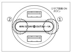
⑦ フロントパネルの①部分(左図)がボタンになっていますので1回押します。押すと、②部分の橙 LED が点灯します。暫く待つと、橙 LED が赤 LED に変わり録画を開始します。少し録画を行った後、①部分を2~3秒長押しして録画を停止します。本体から microSD カードを取り出し、パソコンに入れ、再生ソフトで再生してください。動画に日時情報が入ります。先ほどテキストドキュメントで入力した日時が表示されていることを確認してください。
