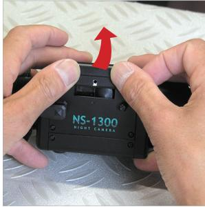
① バッテリーボックスの蓋を開けます(位置: 本体上面真ん中)。写真にある部分を押さえて、上に押して開けます。両手親指を使用すると簡単に開きます。
