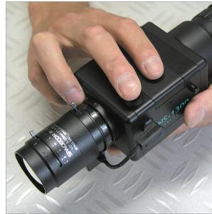
④ 次に本体上面にある、電源ボタンを押します。電源が入り、NS-1300に内蔵されたCCDカメラとLCDモニターが起動します。
