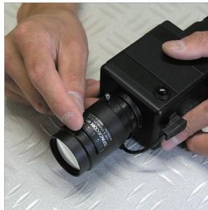
⑦ LCDの映像を確認し、映像を拡大する必要がある場合は調整、レンズ前方のレバーを動かして倍率調整を行います。f5, 6, 8, 12, 16, 25, 55mmから選択が可能です。
