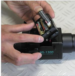
② バッテリーボックス内部には、電池パックが入っています。付属の単三アルカリ電池を6本、極性を間違えないように入れます。電池を入れたら、電池パックをボックスへ戻します。この際、スナップ接続部が本体側面プリント部を向くように入れてください。
