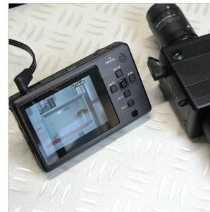
⑪ NS-1300とポリスノート2400を組み合わせて使用したところです。内蔵LCDでは確認しにくい細部も、外部機器に接続すればより鮮明な画像が得られます。
