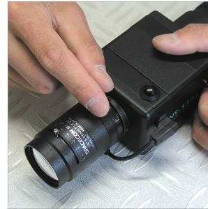
⑧ 倍率調整を行った後、ピント調整を行います。レンズ後方のレバーを動かしてピントを合わせます。
