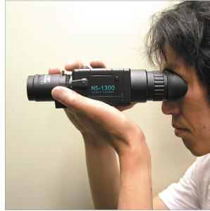
⑤ 接眼部を写真のようにしてのぞきます。内蔵LCDに映し出された映像を見ることができます(次の写真参照)。
