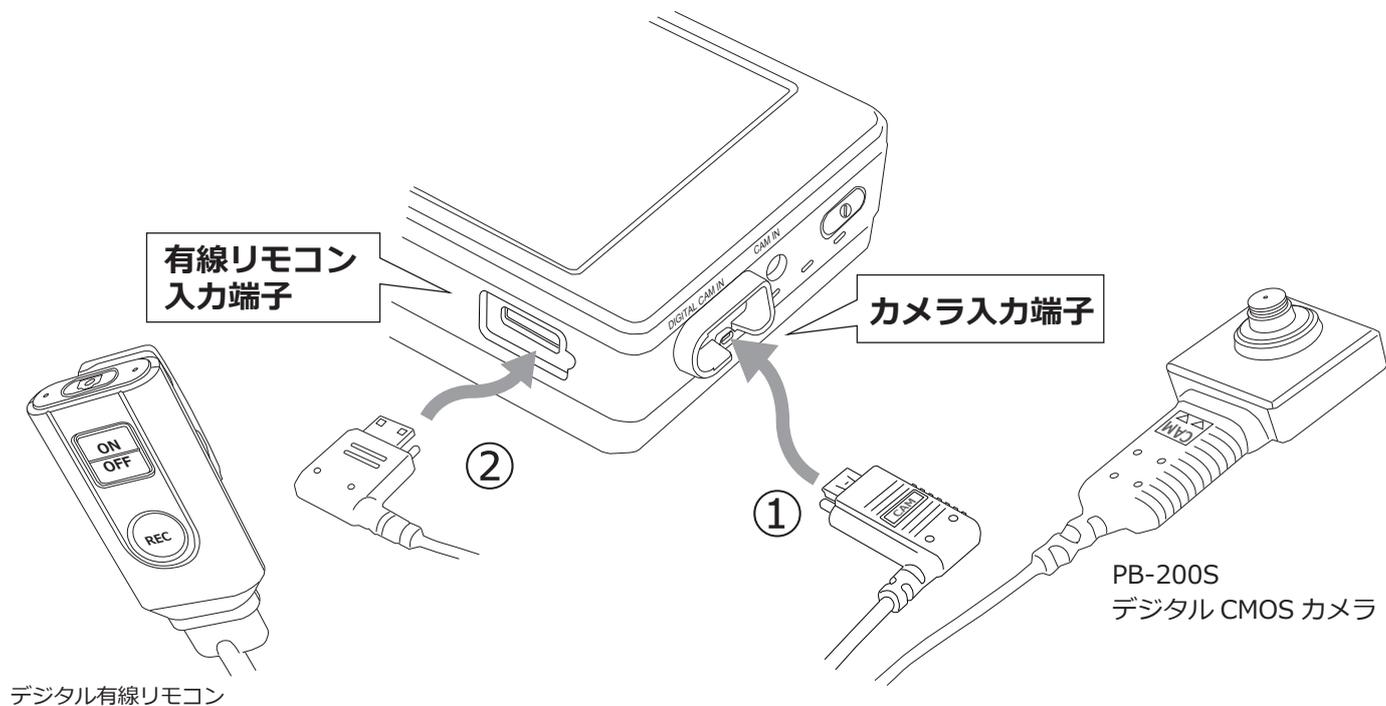
PB70S にはデジタルカメラ用入力端子 (①) と有線リモコン端子 (②) が搭載されています。それぞれ、挿し込む際に端子の向きがあります。十分ご注意ください。
