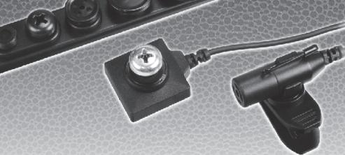
SVR-30Nは撮像素子に省電力の1/4インチCMOS(有効画素30万)を採用した、ボタンおよびネジのレンズカバー(5種類)が付属する小型カメラです。PoliceBookの画像/音声入力用として使えるほか、単体カメラとして9V電池1個でも3時間弱駆動させることができます。
